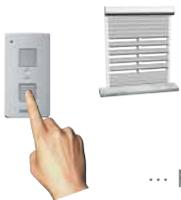
**1<sup>er</sup> appui** : descente du tablier et lames en position ouverte (85°)
