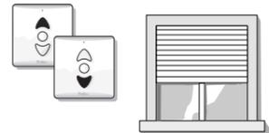
e) Coder l'émetteur à affecter au volet roulant. Appuyer sur le bouton Stop de la télécommande.
